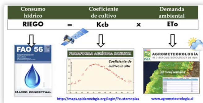
Figura 4. Diagrama del marco conceptual del cálculo del consumo hídrico de los cultivos y fuentes de información disponibles en la Región de Coquimbo.
