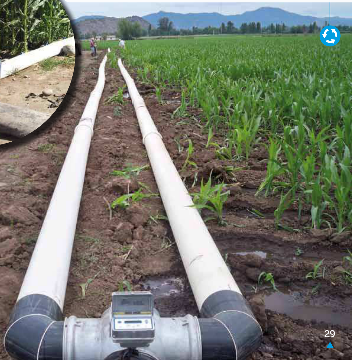
◀ Disposición del equipo en “T” y en “U” con válvula y controlador de pulsos al centro.
