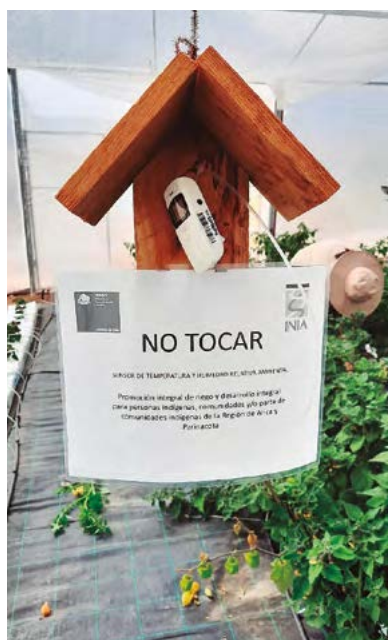
Figura 1. Monitoreo de temperatura y humedad relativa mediante data logger instalado al interior de invernadero, localidad de Lupica.
