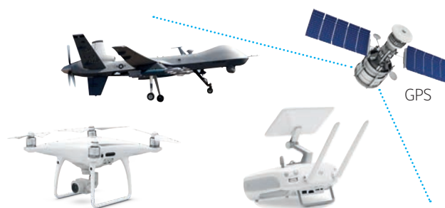
Figura 1. Un dron es un Sistema de Aeronave Pilotada a Distancia, el cual está integrado por la nave, el GPS y el control remoto.
