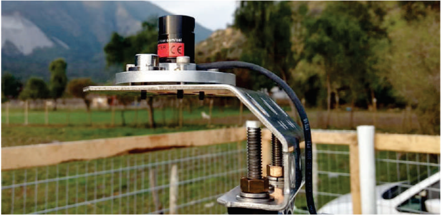
Figura 5. Piranómetro en EMA El Asiento, comuna de Alhué.
