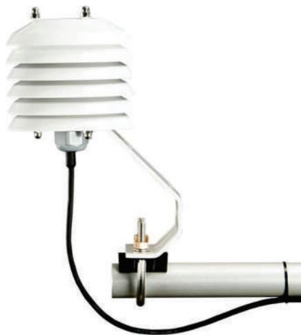
Figura 3. Higrometro inserto en protector de radiación solar. Fuente: campbellsci.es/
