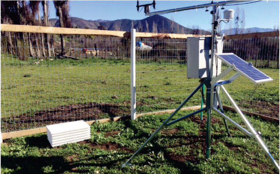
Figura 11. Caseta o pagoda (blanca) para cubrir sensor de temperatura de superficie. EMA El Asiento, comuna de Villa Alhué, región Metropolitana.
