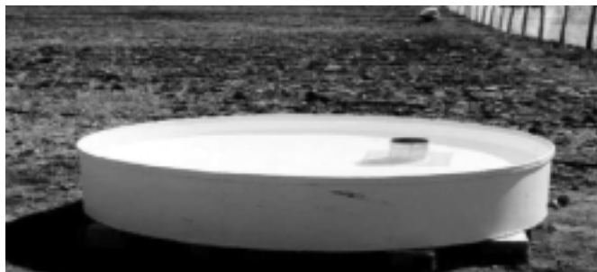
Figura 2. Bandeja de evaporación Clase A.
