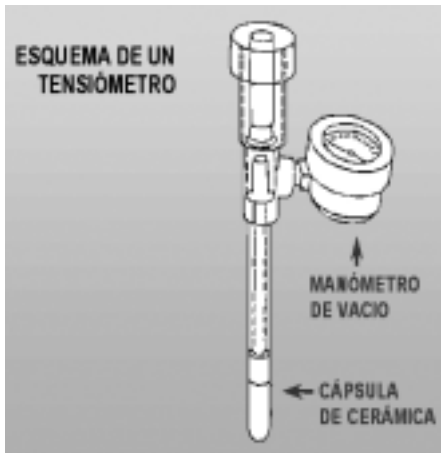
Figura 4. Tensiómetro con manómetro de vacío o vacuómetro.
