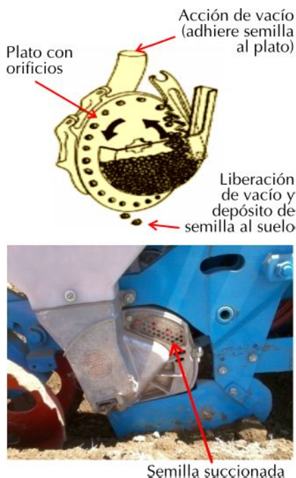
Figura 3. Mecanismo de succión de la semilla
