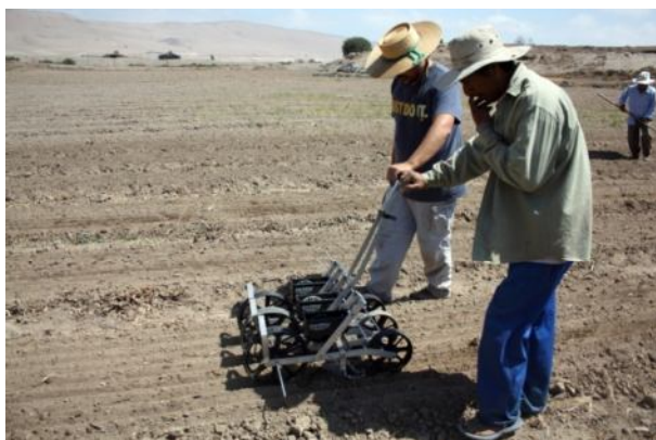
Foto 2. Sembradora manual ensamblada con tres cuerpos de siembra para el establecimiento de almácigos de cebollas en el Valle de Lluta.
