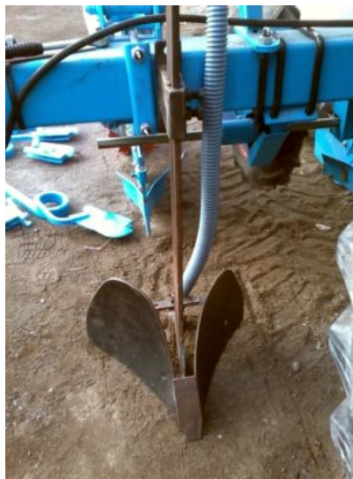
Foto 7. Surcadora incorporada al chasis de la sembradora sembradora neumática de grano marca Monosem.
