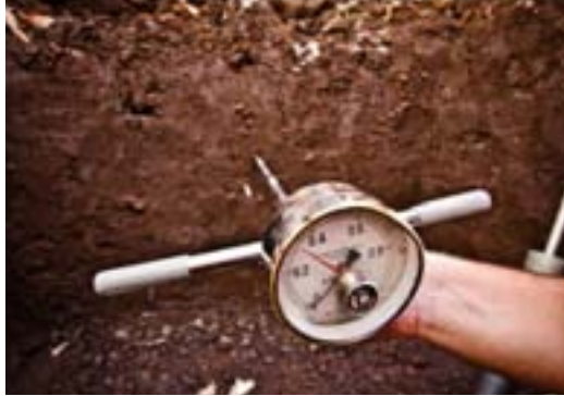
Foto 3. Determinación de la resistencia a la penetración horizontal.
