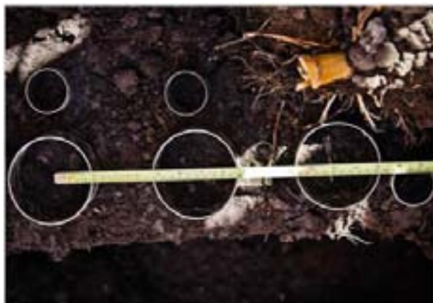
Foto 2. Determinación de la densidad aparente mediante el método del cilindro.
