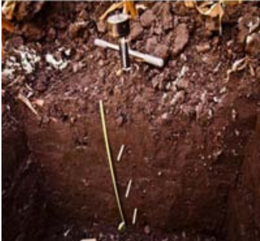
Foto 1. Penetrómetro utilizado para determinar de la resistencia a la penetración vertical.
