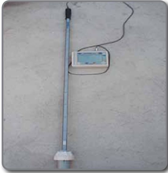
Foto 1. Sonda FDR, con su consola de almacenamiento y captura de datos.
