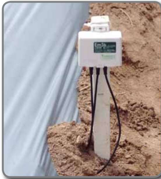
Foto 4. Sensores conectados a sistema de registro y descarga a un computador personal.
