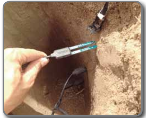
Foto 3. Instalación de sensores ECH_2O
