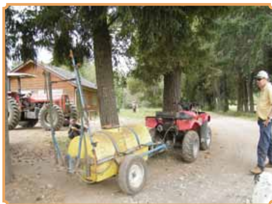
Foto 7. Equipos para el control químico de malezas, barra de aplicación con protector "tipo estrella" (izquierda) y minipulverizador con barra de aplicación lineal (derecha).
