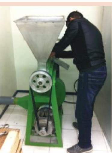
Foto 1. Máquina escarificadora, capacidad de procesamiento de 100 kg h -1 . Instituto de Agroindustria Universidad de La Frontera. Fuente: Susana Valenzuela A.
