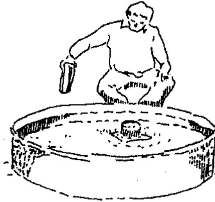
Figura 4. Medición de la evaporación en una bandeja de evaporación Clase A.
