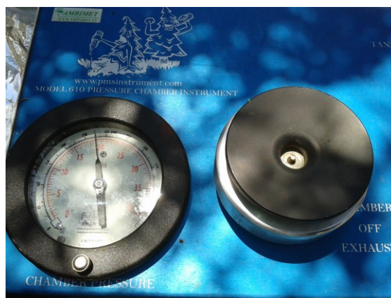
Figura 2. Medición de potencial xilemático. Nótese a la izquierda el manómetro con valor de -1,9 MPa, y a la derecha la ramilla de olivo inserta en la cámara.
