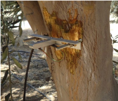
Figura 4. Dendrómetro instalado en tronco de olivo.
