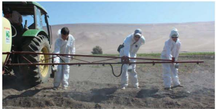
Fotografía 4. Medición del caudal.
