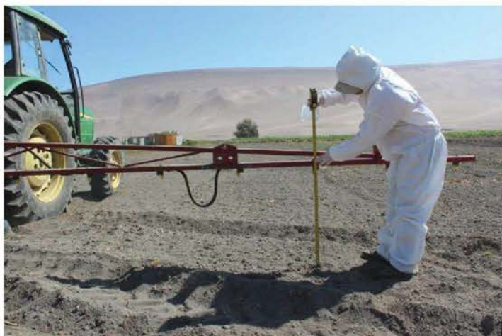
Fotografía 1. Medición de la altura de barra de pulverización.
