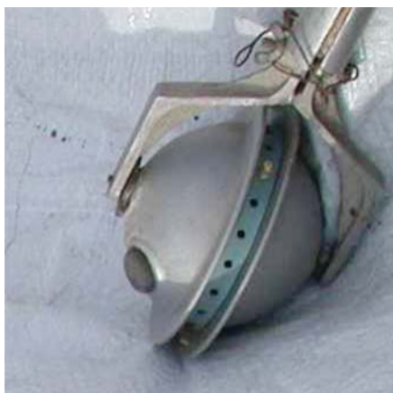
Foto 2. Bastón sembrador de semillas pequeñas de hortalizas. Consta del bastón y una esfera hueca en su extremo que contiene semillas en su interior. Al girar libera las semillas por gravedad, a través de orificios regulables en tamaño gracias a un cintillo PVC perforado, intercambiable, que se ubica en el centro de la esfera.
