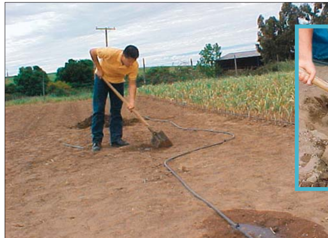
Transcurrido el tiempo de riego, se realizan las determinaciones de diámetro y longitud excavando directamente en la zona media del bulbo de humedecimiento.
