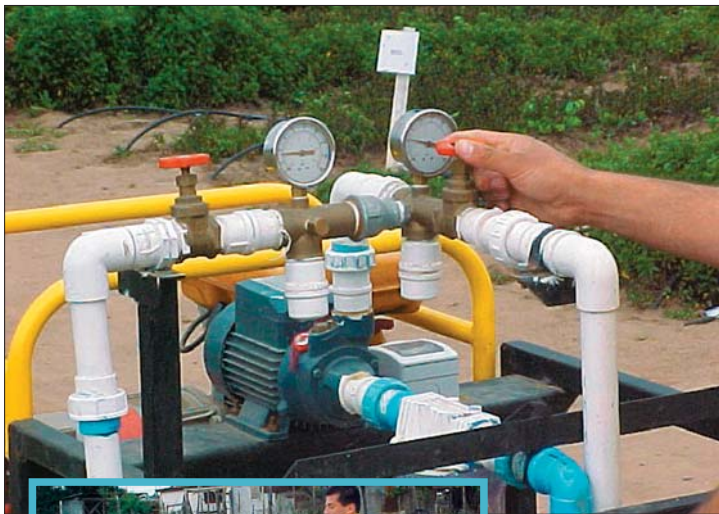
En el momento de la puesta en marcha del equipo se procede a realizar los ajustes de presión mediante las válvulas dispuestas para ello.
