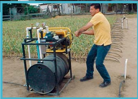
En el momento de la puesta en marcha del equipo se procede a realizar los ajustes de presión mediante las válvulas dispuestas para ello.
