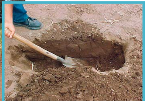
Transcurrido el tiempo de riego, se realizan las determinaciones de diámetro y longitud excavando directamente en la zona media del bulbo de humedecimiento.
