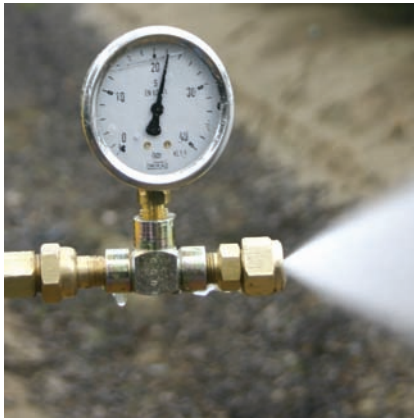
Foto 3. Medición de la presión en el pitón.
