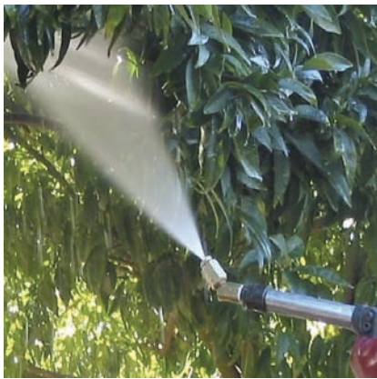
Foto 4. Incorporación de un codo para direccionar la aspersión.
