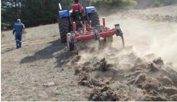
Figura 6. Labor de subsolado entre 35 a 40 cm de profundidad, con cinco puntas, para romper capa compactada de suelos. Centro Experimental Hidango, Instituto de Investigaciones Agropecuarias (INIA).
