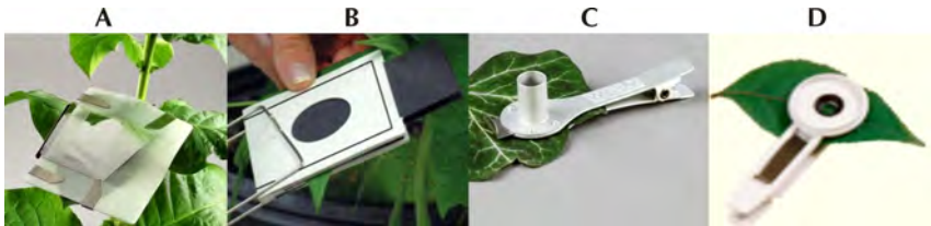
Figura 6.3. Pinzas de adaptación a oscuridad adaptable a fluorómetros, según modelo. A) Walz Company. B) LI-COR®. C) Walz Company. D) Hansatech Instruments. Imágenes obtenidas desde páginas web ( www.licor.com ; www.walz.com y www.ppsystem.com )
