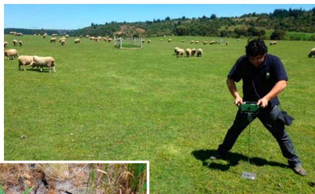
Foto 1. Medición del nivel de compactación con Penetrómetro digital.
