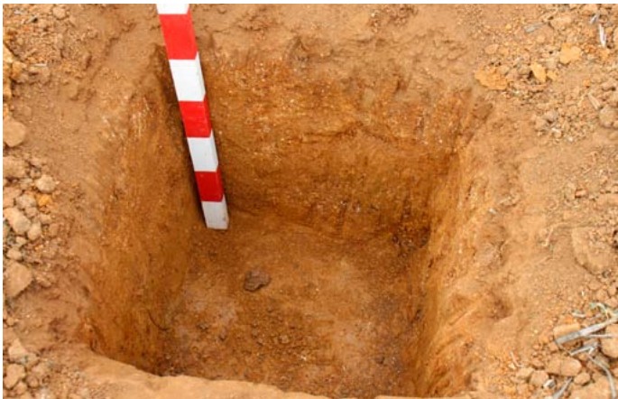
Foto 2. Calicata para reconocimiento y estudio del perfil de suelo.
