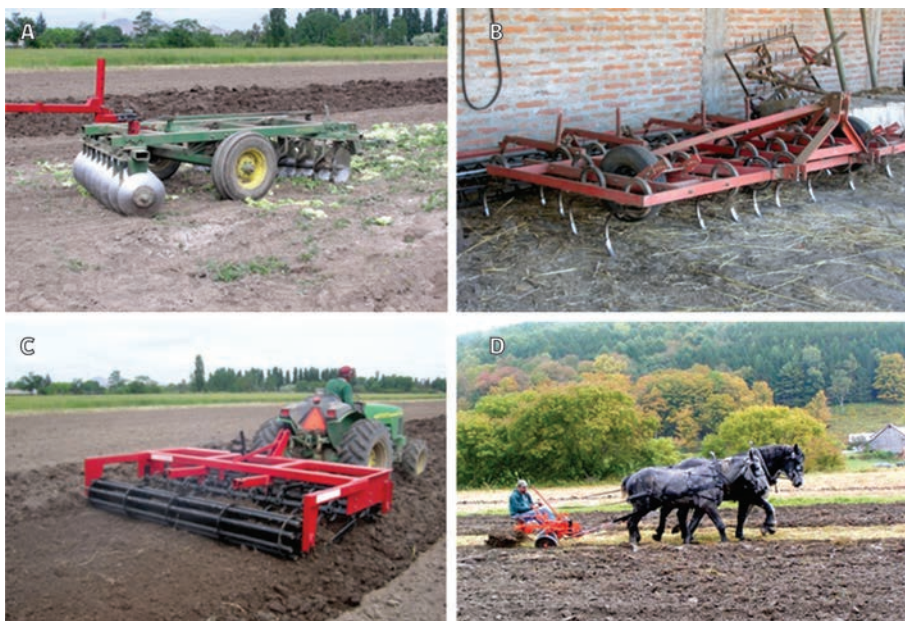
Figura 5.2. Diferentes implementos para realizar labranza secundaria de acuerdo a los objetivos requeridos. A) Rastra de discos offset. B) Vibrocultivador. C) Vibrocultivador trabajando. D) Rastra de tiro animal.
