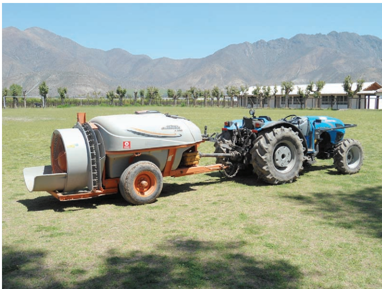
Figura 10.2. Pulverizador hidroneumático para aplicaciones de plaguicidas en frutales.
