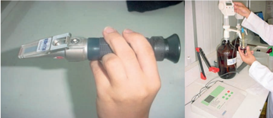
Figura 2.1. Instrumentos para medición de sólidos solubles totales (refractómetro a la izquierda) y acidez titulable (potenciómetro a la derecha).
