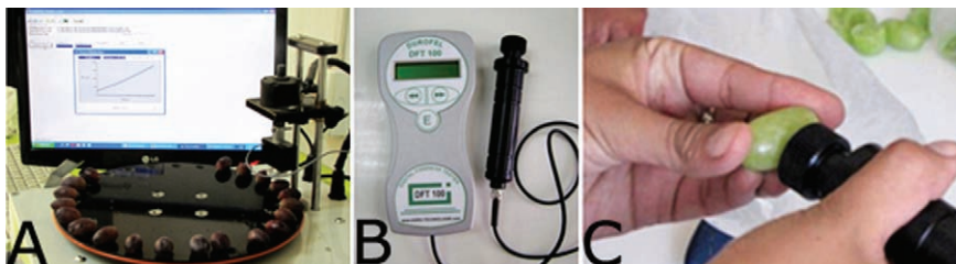
Figura 2.13. Instrumentos para la determinación de firmeza en uva de mesa. A y B) FirmtechII y C) Durofel.
