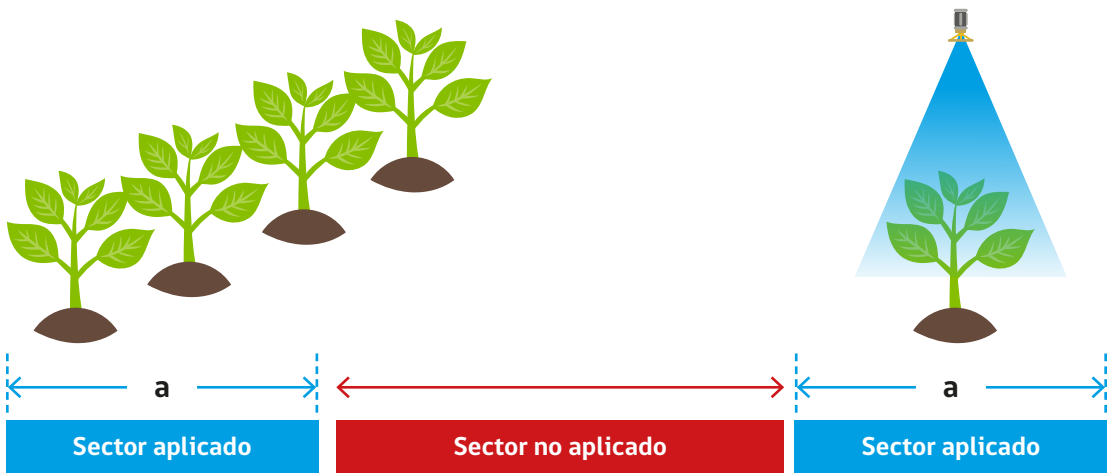
Figura 4. Aplicación por sobre las hileras cuando las plantas están pequeñas o son de bajo porte. "La superficie a aplicar se relaciona a la superficie de suelo tratado"
