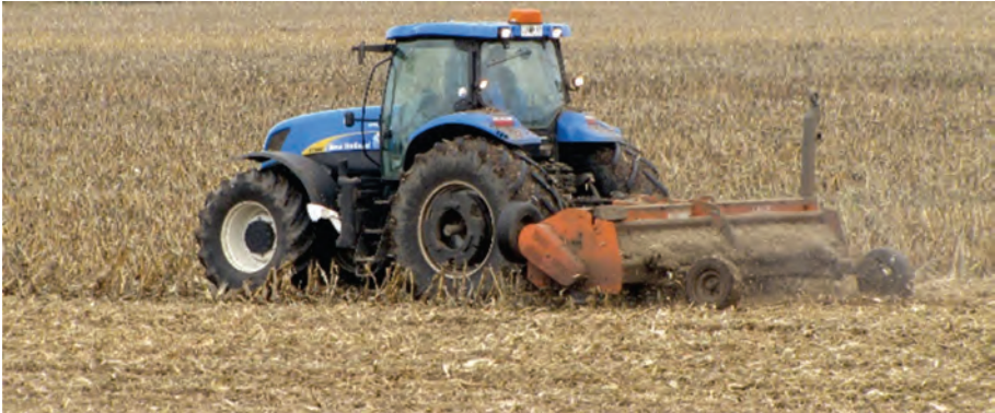
Figura 3. Tractor y equipo picador-triturador de rastrojos, en labores de manejo de acondicionamiento de los mismos, previo a su incorporación al suelo.
