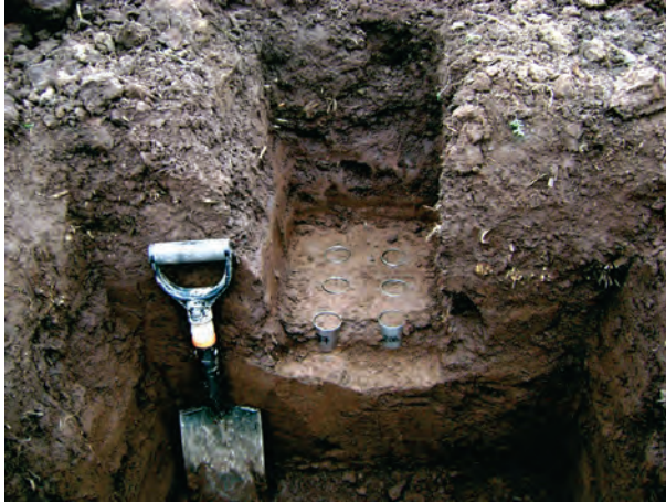
Figura 2. Proceso de muestreo de suelos con cilindros, para análisis físicos del mismo. Chépica, año 2015
