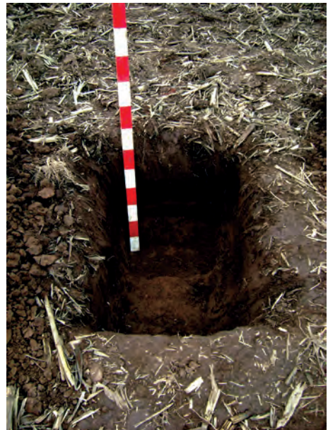
Figura 1. Calicata, excavación hecha en el terreno, para la inspección directa del suelo.
