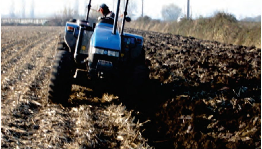
Figura 1. Forma de trabajo del arado de vertedera y tractor. Obsérvese las ruedas de un lado del tractor circulando por el interior del último surco de aradura.
