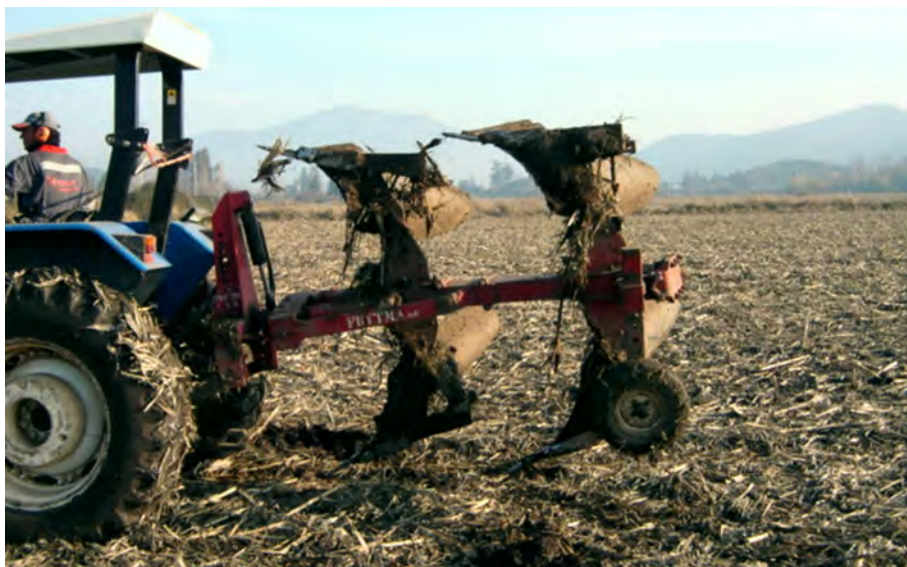
Figura 3. Arado de vertedera reversible, equipo adecuado para la incorporación de rastrojos de Maíz.
