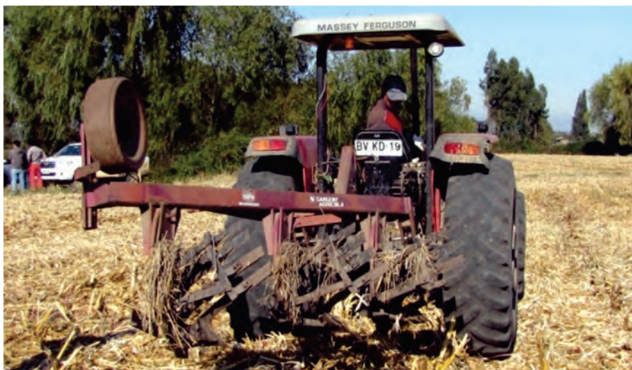
Figura 4. Arado de vertedera “listonado” o de rejilla. Adecuado su uso para suelos arcillosos o gredosos.
