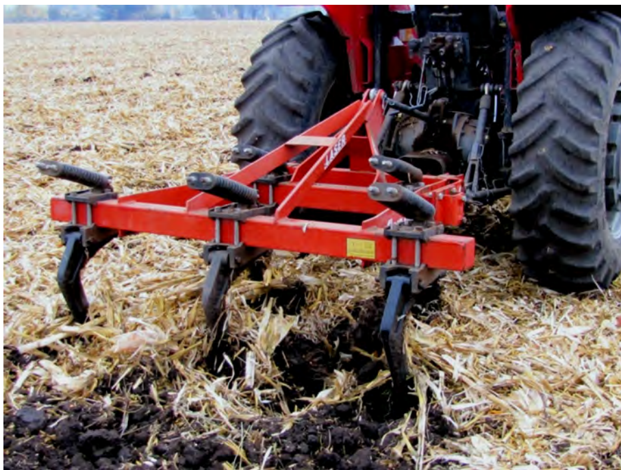
Figura 2. Arado subsolador-escarificador de tipo integral, compuesto de cinco brazos de rotura montado en el "chasis" del equipo
