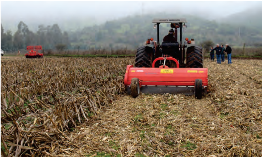
Figura 1. Equipo triturador y picador de rastrojos, equipo adecuado para el manejo de ellos.
