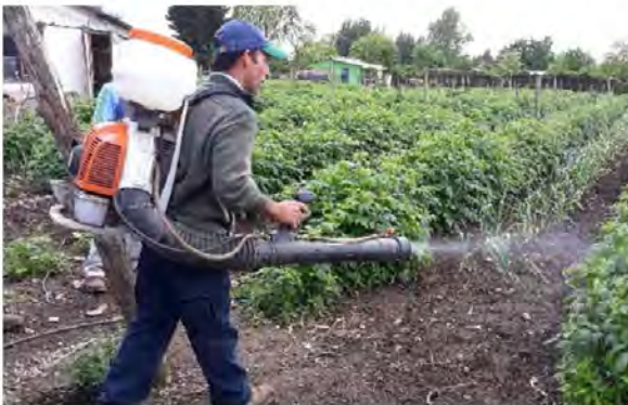
Foto 1. Pulverización con equipo neumático de mochila, conocido comúnmente como "motopulverizadora".
