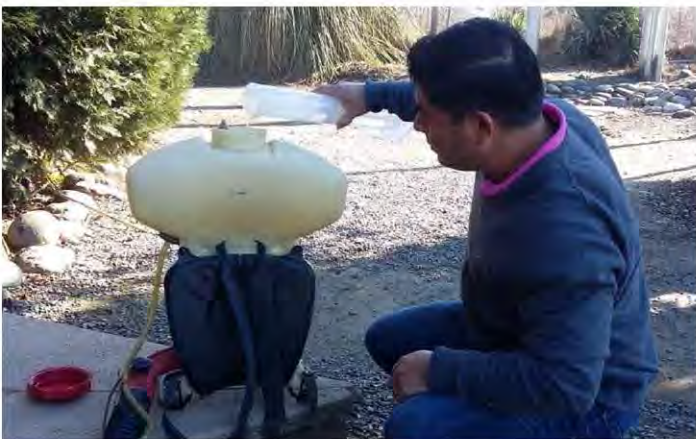
Foto 4. Relleno con agua hasta el nivel marcado inicialmente (debe ser en el mismo lugar utilizado inicialmente).
