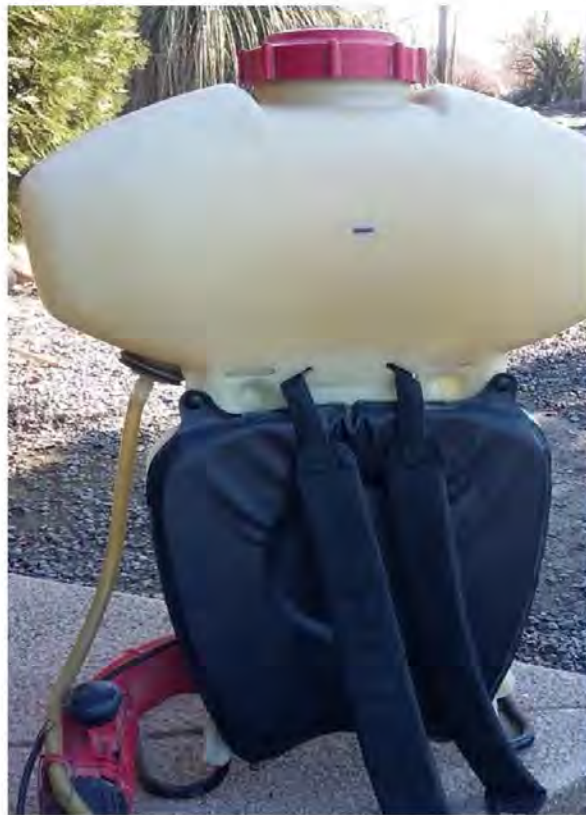
Foto 2. Marca con lápiz en el estanque con nivel de agua inicial en lugar nivelado.
