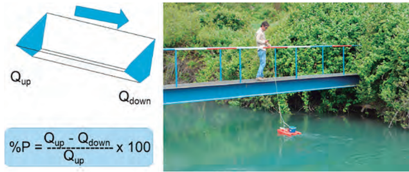
Figura 2. Medición de pérdidas con ADCP. Cálculo de pérdidas (%P), donde caudal aguas arriba (Qup) y aguas abajo (Qdown).
