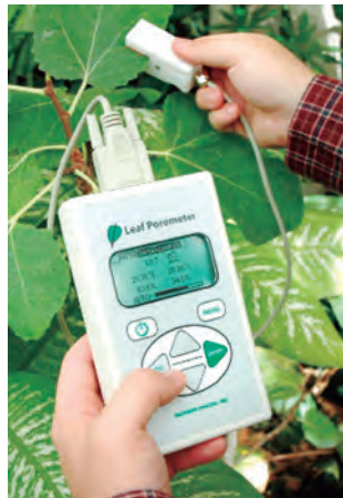
⬆ Figura 6. Leaf Porometer Model SC-1. Porómetro Foliar, este instrumento permite medir la conductividad estomática.
