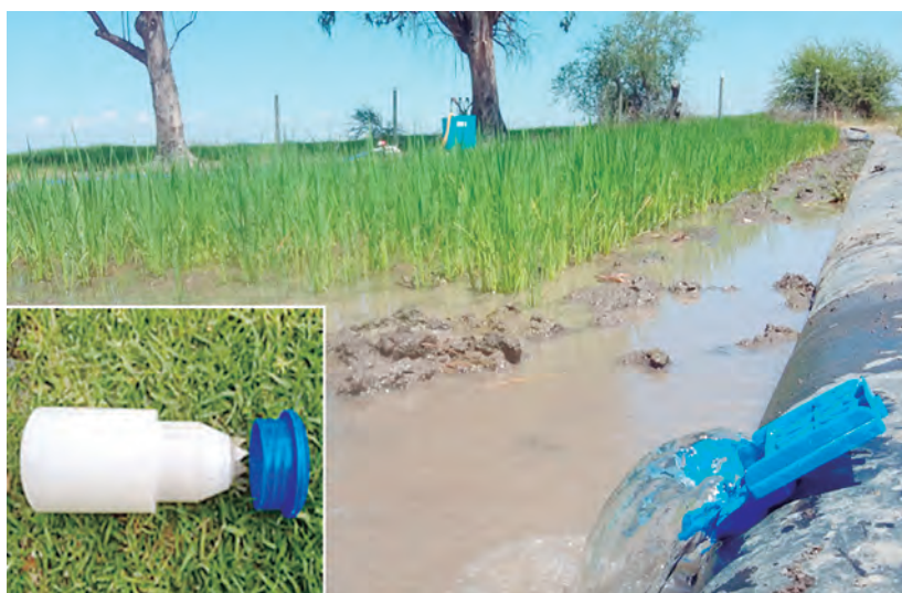
↑ Figura 4. Manga y compuerta de riego. A la izquierda se observa en color blanco el insertor que permite colocar las compuertas en las mangas de riego cuando éstas tienen presión de agua.
