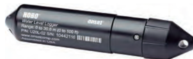
↑ Figura 3. HOBO U20L-04, sensor de nivel y temperatura (con datalogger), para medir en forma constante el caudal de un canal que abastece de agua a las parcelas. Para ello, el sensor debe estar instalado en una canaleta Parshall.
