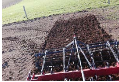
Figura 3.6. Labranza secundaria con uso de vibrocultivador.
