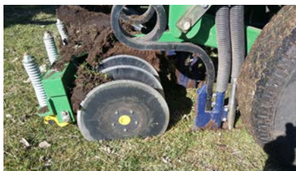
Figura 3.14. Sembradora CL de zapatas, marca Aitchison.
