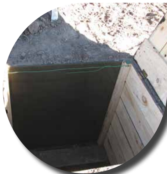
► Foto 3. Estructura básica de un Rizotrón construido en madera con pared de vidrio para la observación del crecimiento de raíces.
