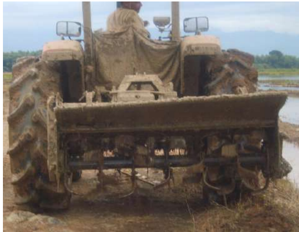
Foto 2. Rotovator equipo para la incorporación del rastrojo en la preparación de suelo.
