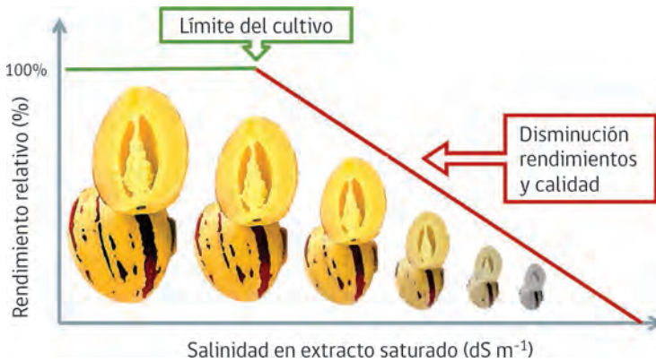
Figura 7.14. Esquematización que representa el límite tolerado por el cultivo de pepino dulce en cuanto a salinidad medida en extracto saturado 2,5:1. Superado este límite, los modelos indican que existe un decaimiento lineal de los rendimientos, que en el caso de pepino dulce se refiere a unidades comercializables.
