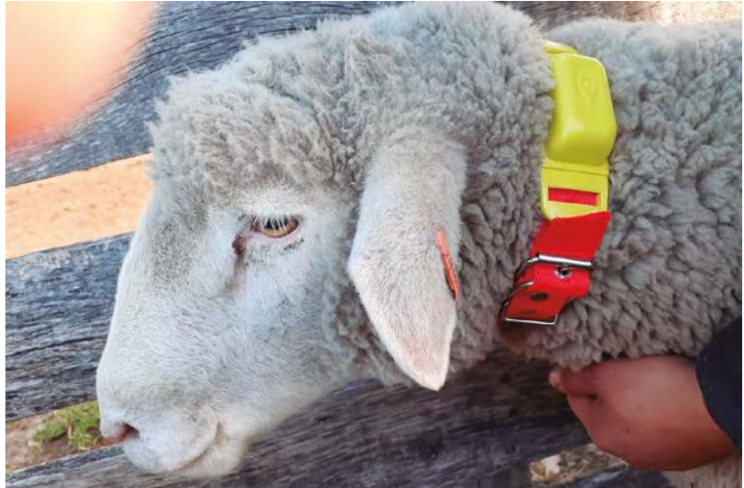
📍 Figura 2. Collar GPS que se comunica via LoRA, que permite determinar la ubicación de los animales en tiempo real.
