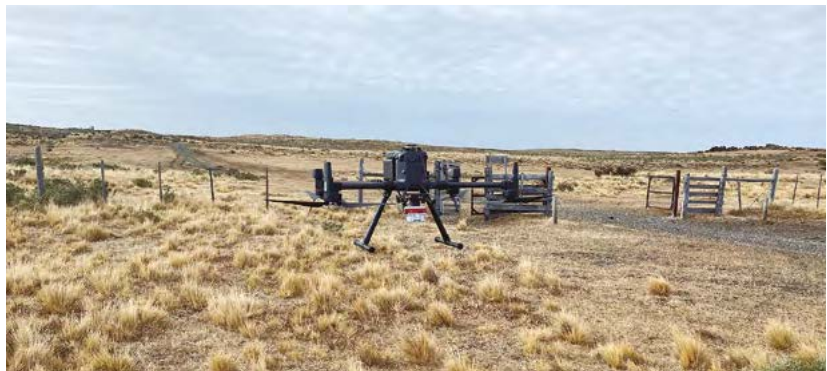
📍 Figura 1. Uso de dron y cámaras multiespectrales, para determinar disponibilidad de materia seca en campos de Magallanes.
