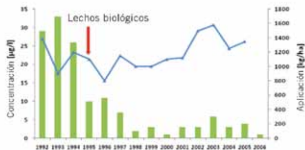
Figura 2. Efecto de la instalación de lechos biológicos en Suecia (flecha roja indica año de instalación). Promedio del total de plaguicidas aplicados (kg/ha) (línea continua) y concentración de plaguicidas encontrados en ríos de las cuencas en estudio (barras).
