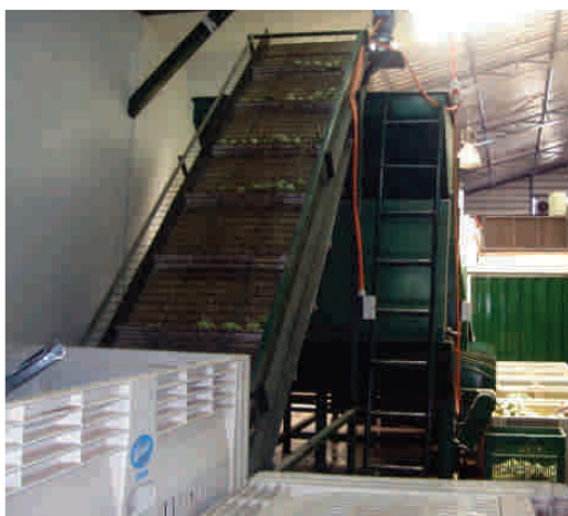
Recepción de alcachofas y clasificación por calibres antes de entrar a las máquinas de corte.
