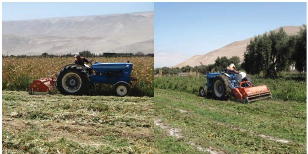
Foto 4. Máquina trituradora de rastrojos en cultivos de maíz (a) y berenjena (b), en el valle de Azapa.
