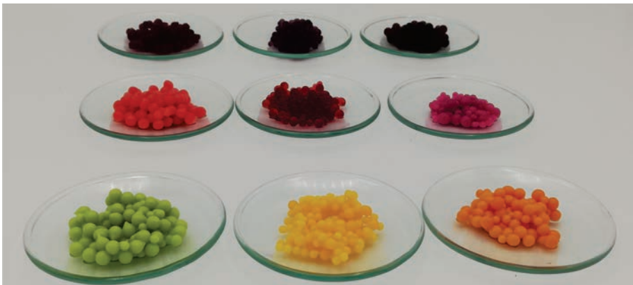
Figura 4.7. Encapsulados obtenidos en el laboratorio de alimentos mediante gelificación iónica desde extractos vegetales, donde: verde es alfalfa; amarillo, pétalos dedal de oro; naranja, camote naranja; rojo, papa PPC roja; púrpura, zanahoria morada; morado, papa PPC morada; negro, tres diluciones de extractos de calafate (Fuente: Laboratorio UMPA - INIA).
