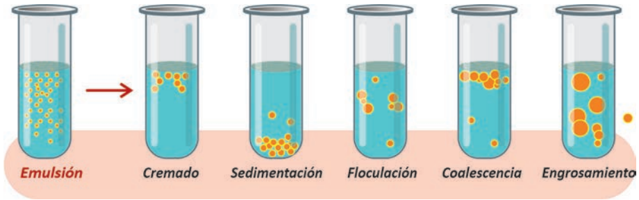
Figura 4.17. Mecanismos de inestabilidad de las emulsiones (Fuente: elaboración propia de M.X. Quintanilla).
