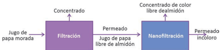
Figura 4.3. Síntesis del proceso para la obtención de un concentrado de color libre de almidón (Fuente: elaboración propia de C. Astudillo).
