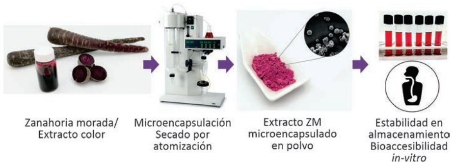
Figura 4.8. Proceso de microencapsulación mediante secado por atomización de jugo concentrado de antocianinas de zanahoria morada, etapas de proceso y evaluación de estabilidad en almacenamiento y digestión simulada in-vitro (Fuente: Laboratorio UMPA-INIA).
