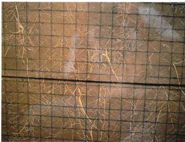
El rizotrón ubicado en la pared de la excavación más cercano a la planta, permite medir el crecimiento de las raíces, utilizando como referencia las líneas verticales y horizontales.
