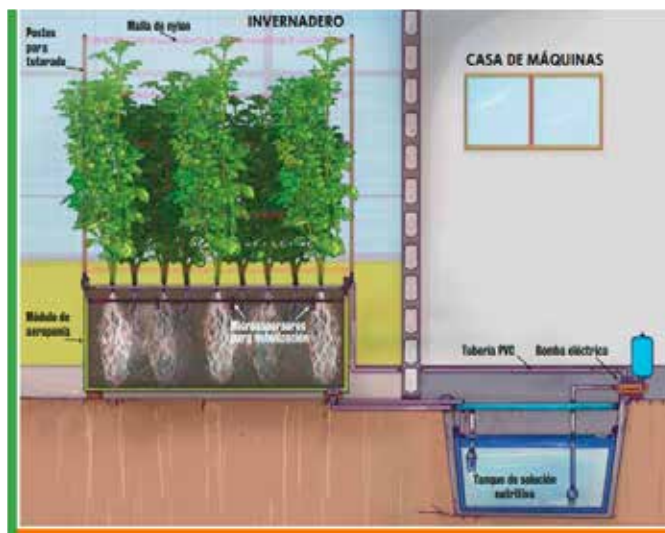
Fig 7. Esquema simplificado papa aeroponía. Fuente. Centro Internacional de la Papa (CIP), 2015
