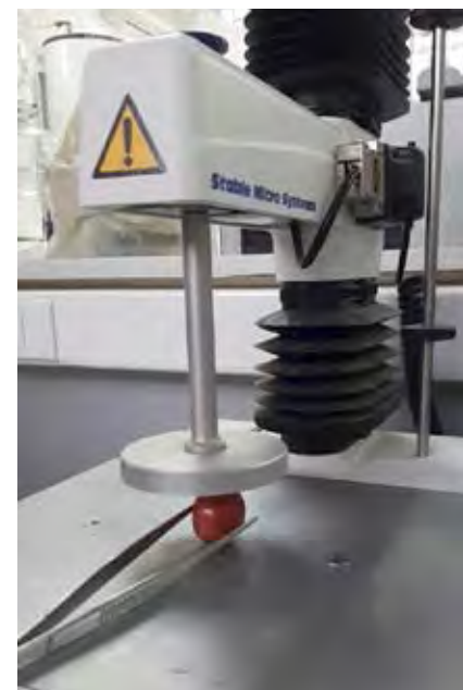
Figura 2. Medición de firmeza mediante deformación de los frutos de cerezas.
