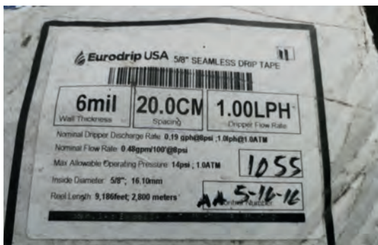
Figura 11.3. Carrete de cinta de riego, en el cual es fabricante proporciona los datos de espesor de la pared, separación de los goteros ( spacing ) y caudal del gotero ( dripper flow rate ).
