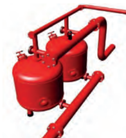
Figura 11.13. Filtro de arena o grava.
