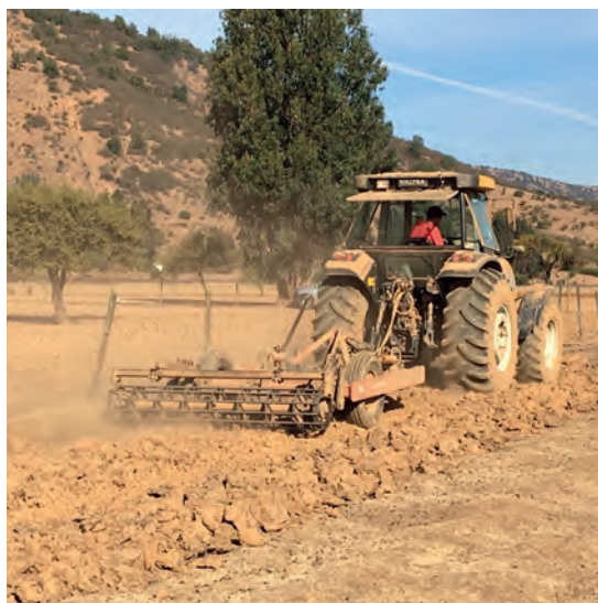
Figura 7.1. Arado escarificador de arrastre, de cinco puntas, con rodillo para fragmentación de terrones.
