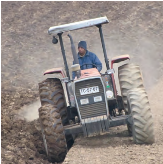
Figura 7.3. Origen del problema de pie de arado por el tránsito de las ruedas de un lado del tractor en el interior del último surco de aradura. Arados de disco o vertedera.
