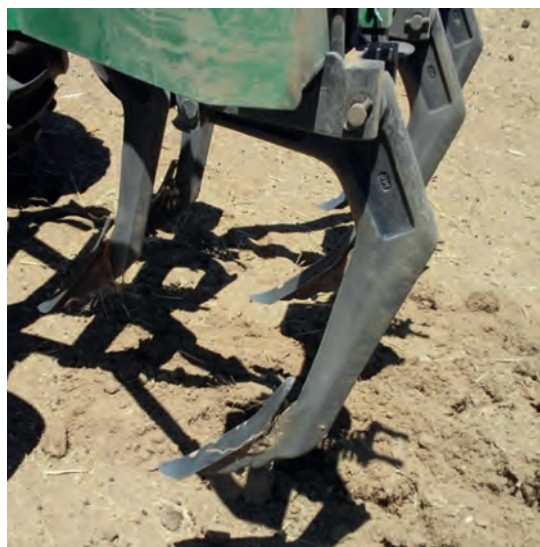
Figura 7.2. Puntas del arado escarificador, adosadas a brazos montados en un marco porta herramienta.
