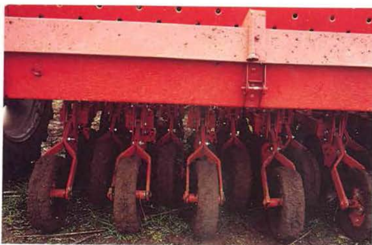
Las ruedas compactadoras contribuyen a asegurar un buen contacto entre el suelo y la semilla.
