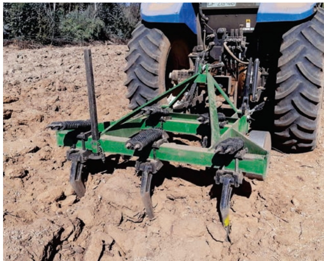
Figura 1. Labor de escarificado del terreno para la rotura del suelo y facilitar en él la infiltración y acumulación de aguas-lluvia.
