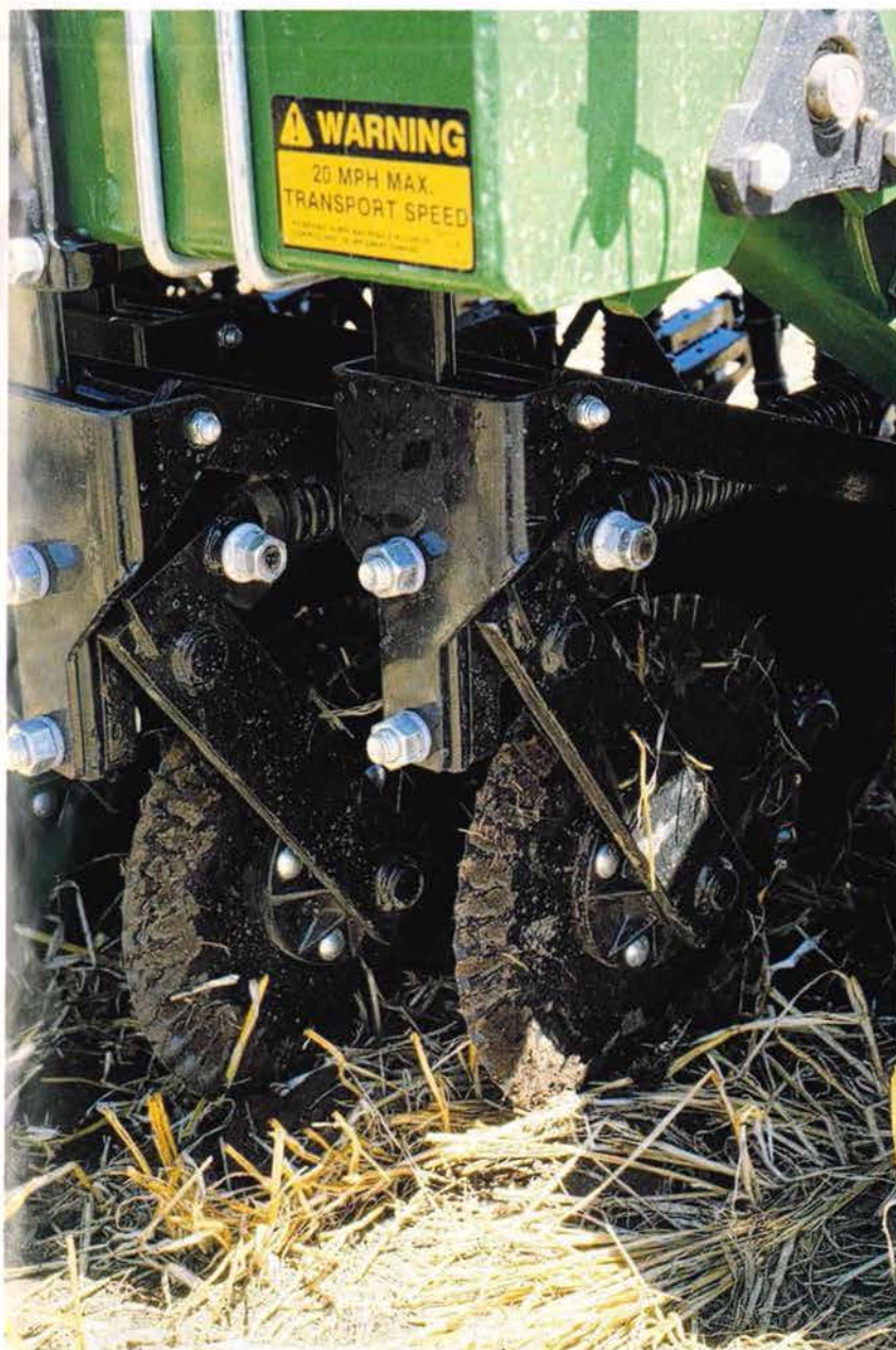
Disco cortador de rastrojo y abridor de surco en sembradora de cero labranza.
