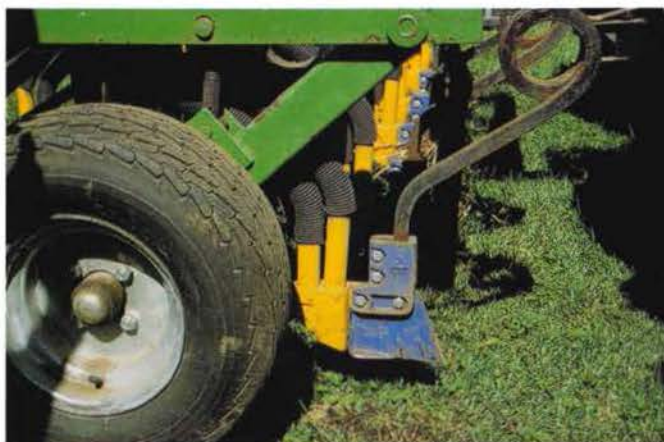
Abresurco tipo cincel de una sembradora.
