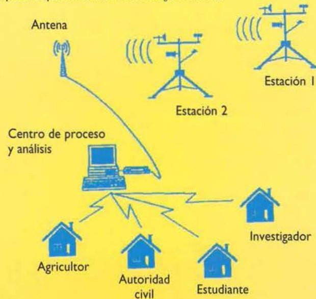
Figura 2. Esquema de operación de una red meteorológica automática
