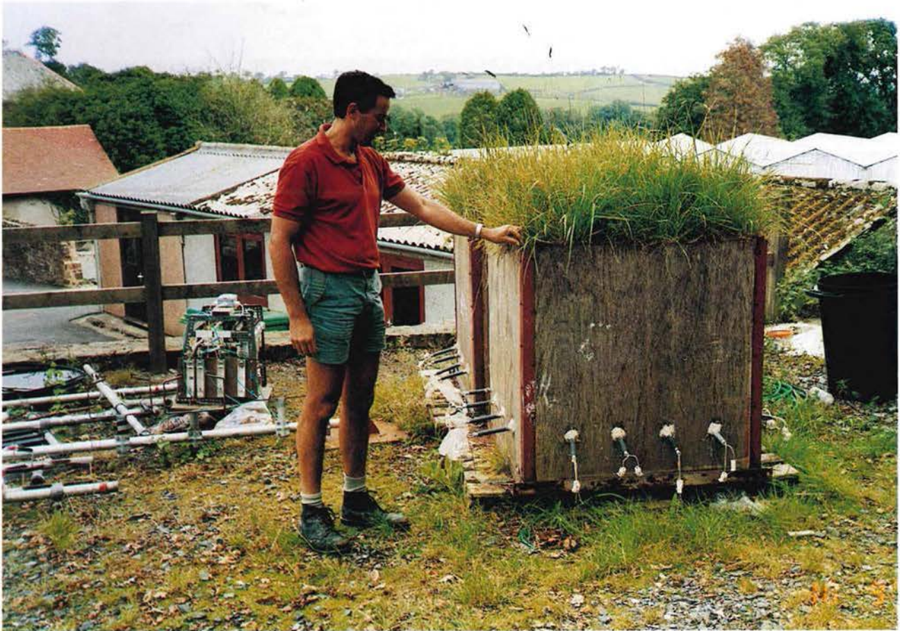
Lisímetro para determinar la pérdida de nutrientes en North Wyke Research Station (Reino Unido).
